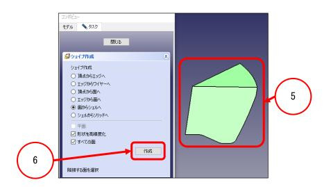
この操作で、結合されたサーフェイスがシェルに変換されます。 ("シェル"は、中が空洞の状態のモデルです。)
